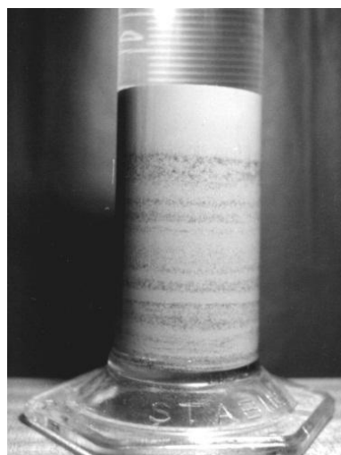
Figure 2 - Lamination résultant d'un écoulement à sec
