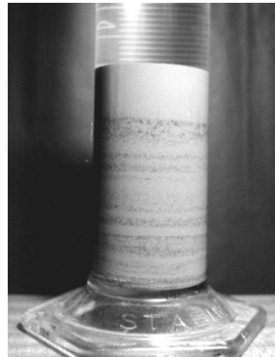
Figure 2 - Lamination résultant d'un écoulement à sec
