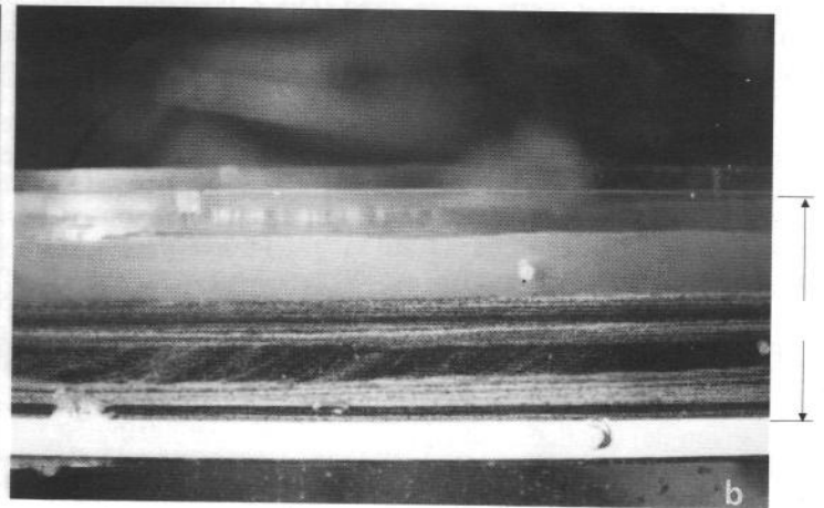
FIG. 8b. - Typical longitudinal view of deposit (flow from right to left). FIG. 8b. - Coupe longitudinale typique du dépôt (écoulement vers la gauche).
