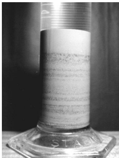
Figure 2 - Lamination résultant d'un écoulement à sec
