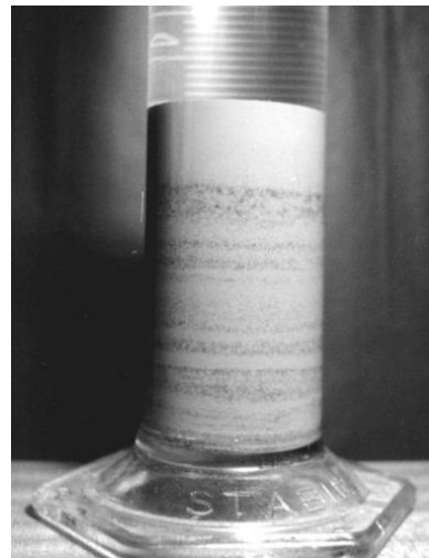
Figure 2 - Lamination résultant d'un écoulement à sec
